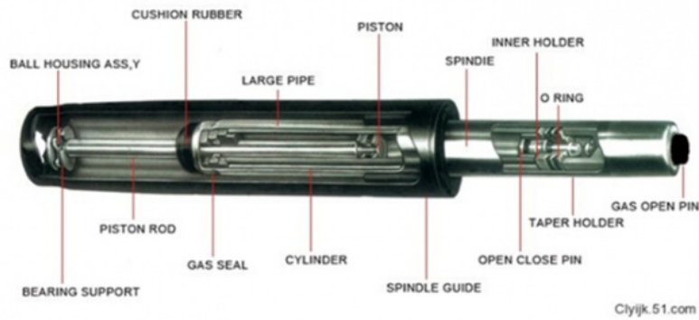
气压棒结构图 The Internal Structure
